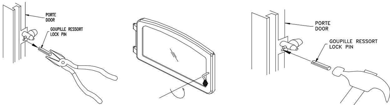
Figure 1: Ajustement de la porte
